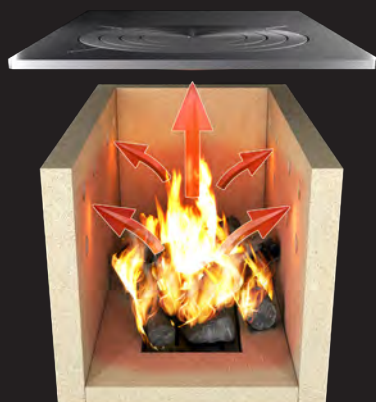
Phase 1: Accumulation et restitution de la chaleur dans le foyer en matériau réfractaire pendant la combustion
